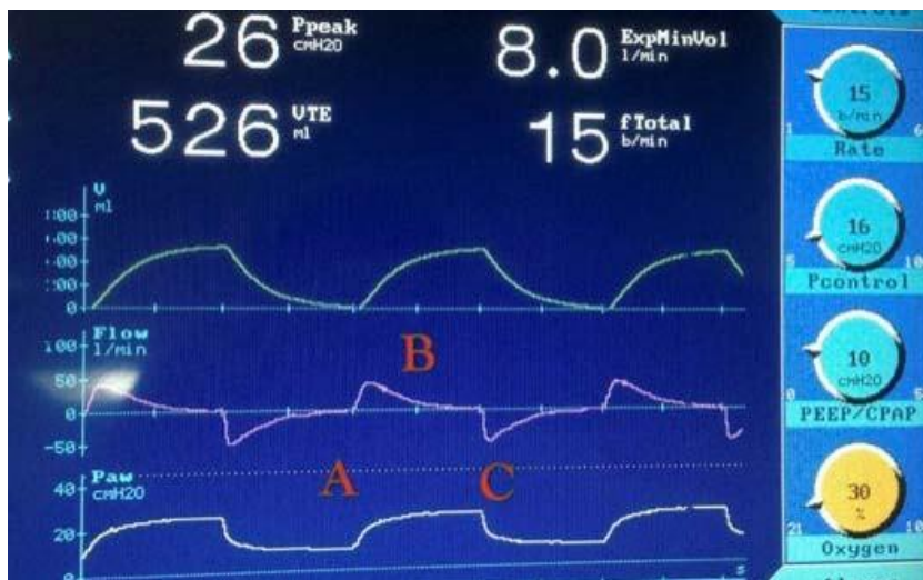
Figura 10. As fases de um ciclo ventilatório são determinadas por disparo, limite e ciclagem. A representa o disparo; B, o limite; e C, o fim da inspiração ou o início da expiração.
