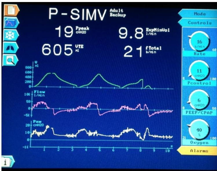
Imagem 3. Tela do ventilador mostrando flutuações na pressão e no fluxo.
